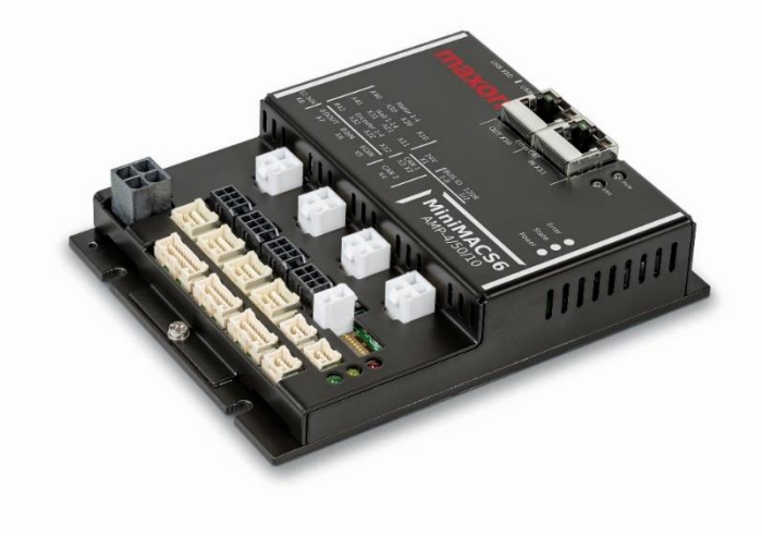
MiniMACS6-AMP-4/50/10-IF1 (IF1: avec carte d'option EtherCAT Slave)
