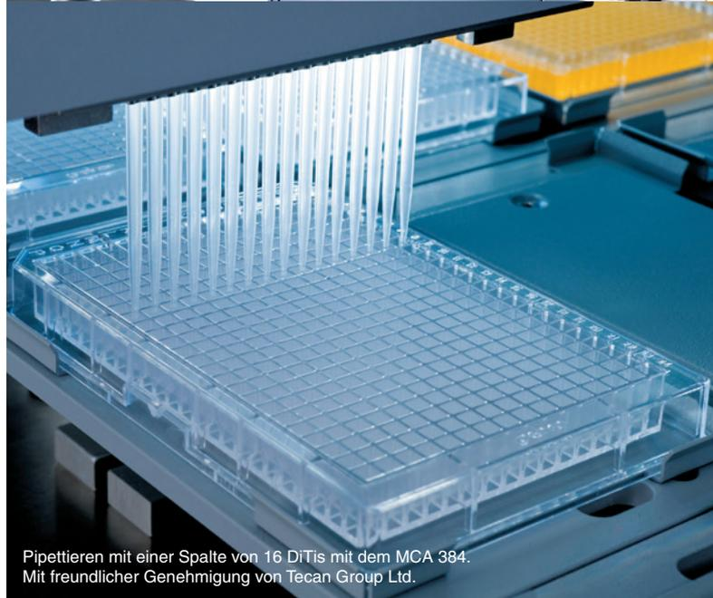
Pipettieren mit einer Spalte von 16 DiTs mit dem MCA 384.
